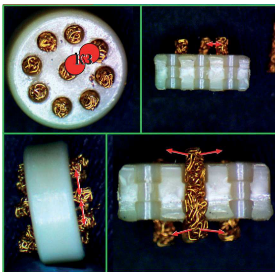
Рис. 1. Области возникновения КЗ между проводниками СВЧ-соединителя
