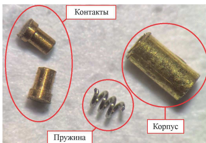
Рис. 8. Изготовленные детали разрабатываемого пружинного контакта
