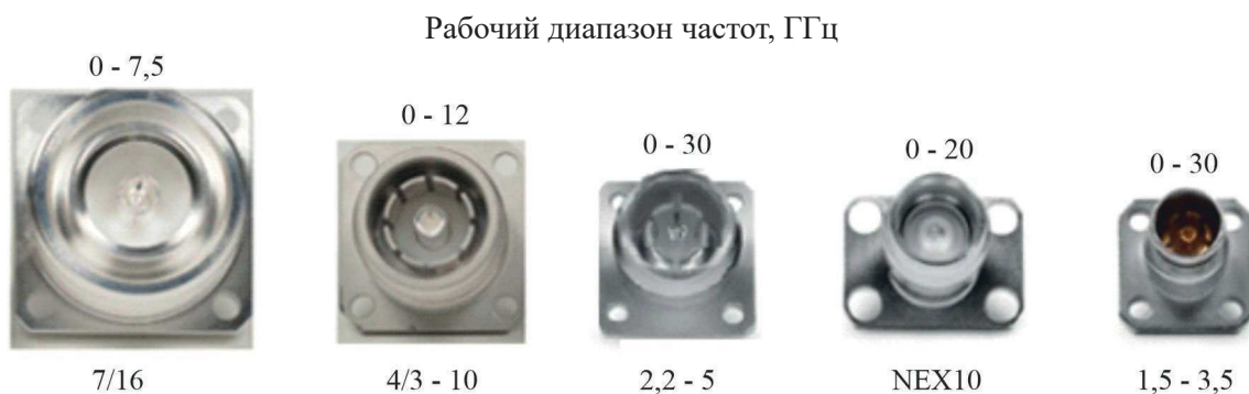
Рис. 2. Соединители 7/16, 4/3-10, 2,2-5, NEX10 и 1.5-3.5
