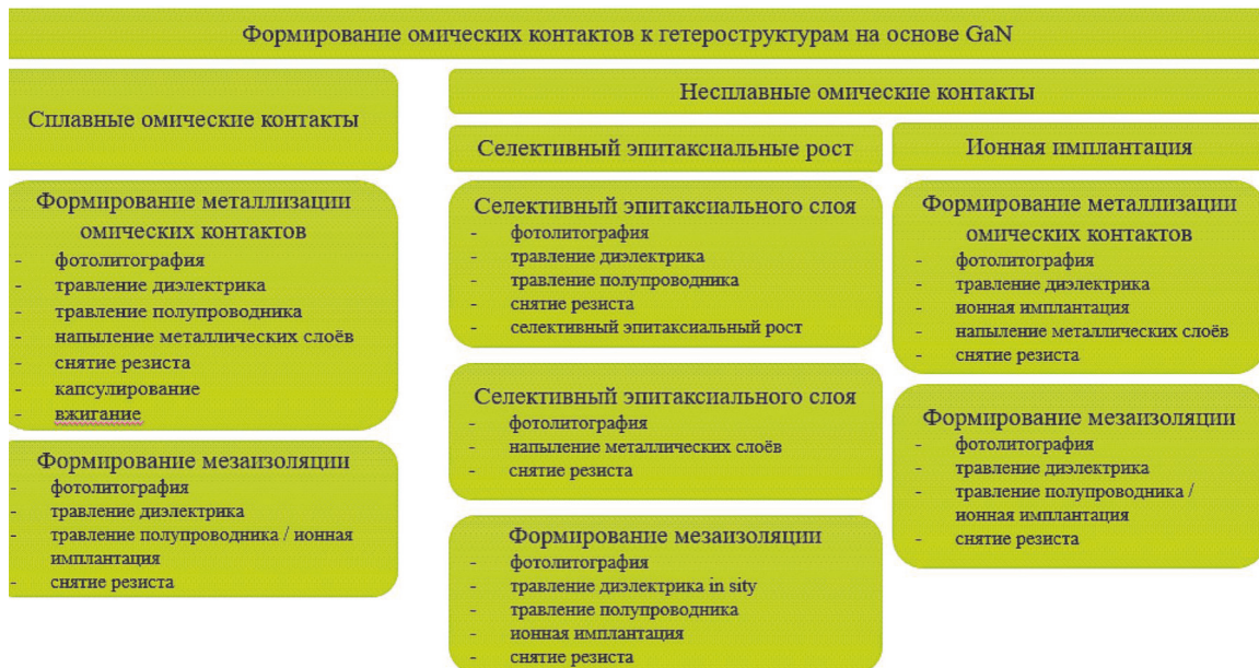
Рис. 8. Упрощённая схема формирования омических контактов к гетероструктурам на основе нитрида галлия различными способами
