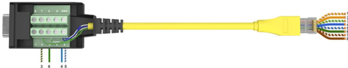
Рисунок 1 – Распределение контактов разъемов кабеля консольного RJ45-DB9
