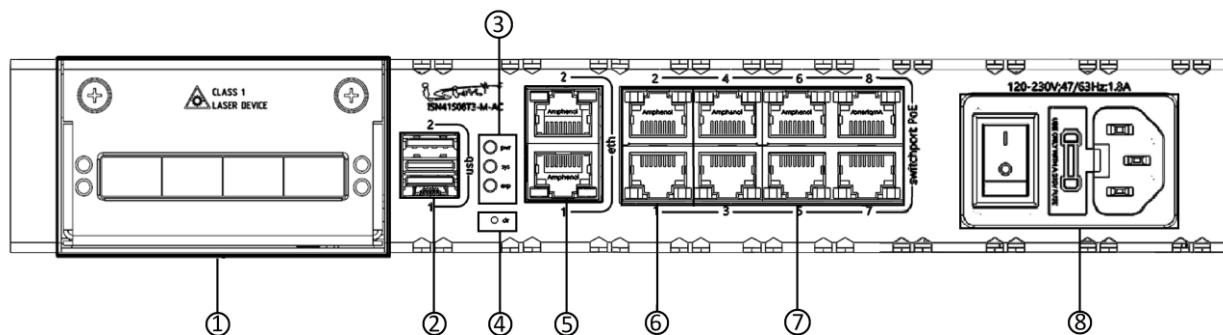
Рисунок 20 – Конфигурация элементов передней панели изделия ISN41508T3-M-AC/ISES0108
