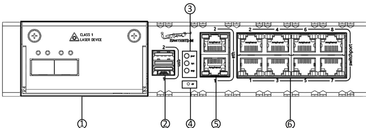
Рисунок 16 – Конфигурация элементов передней панели изделия ISN41508T3-M/ISES0116
