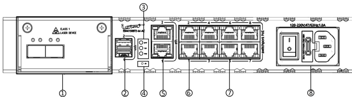
Рисунок 22 – Конфигурация элементов передней панели изделия ISN41508T3-M-AC/ISES0116
