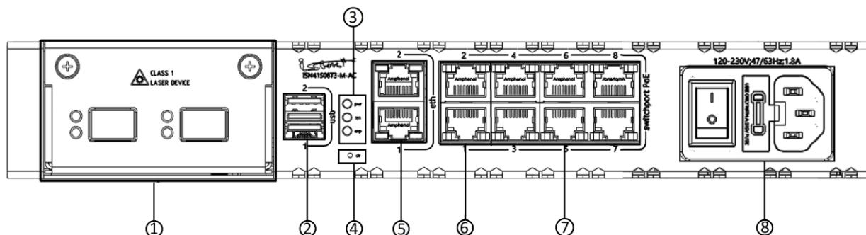
Рисунок 18 – Конфигурация элементов передней панели изделия ISN41508T3-M-AC/ISES1004
