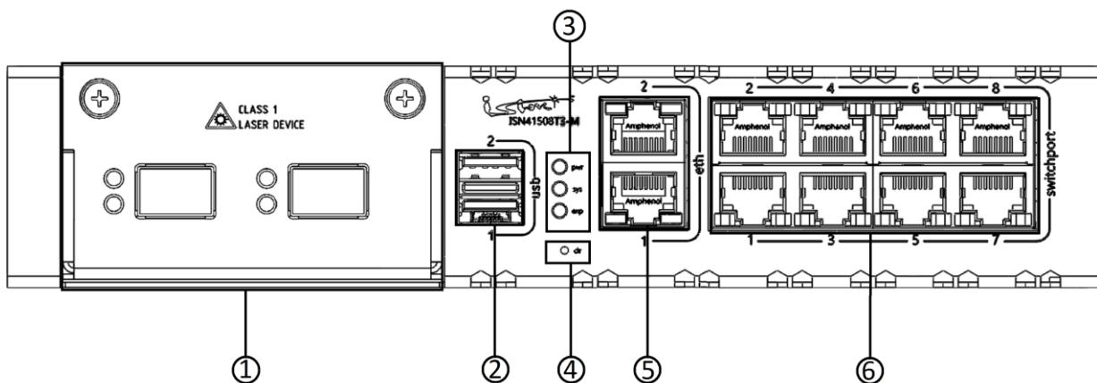
Рисунок 12 – Конфигурация элементов передней панели изделия ISN41508T3-M/ISES1004
