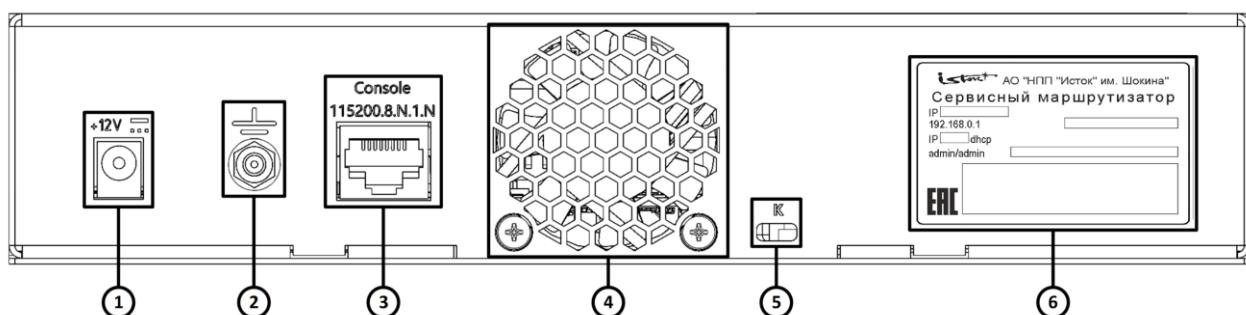
Рисунок 3 – Конфигурация элементов задней панели изделия ISN41508T3
