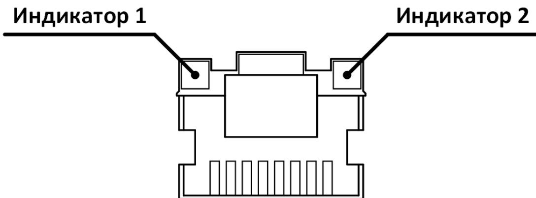
Рисунок 29 – Индикаторы состояния медных интерфейсов Gigabit Ethernet
