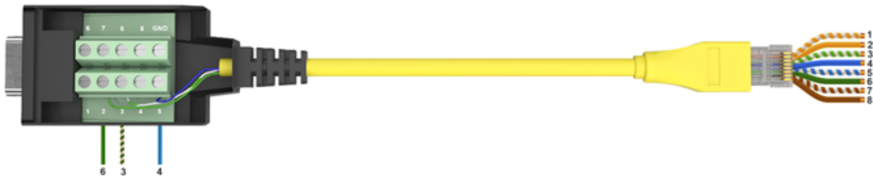
Рисунок 2 – Соединения разъемов консольного кабеля RJ45-DB9 для СМ, выпущенным ранее 01.05.2024
