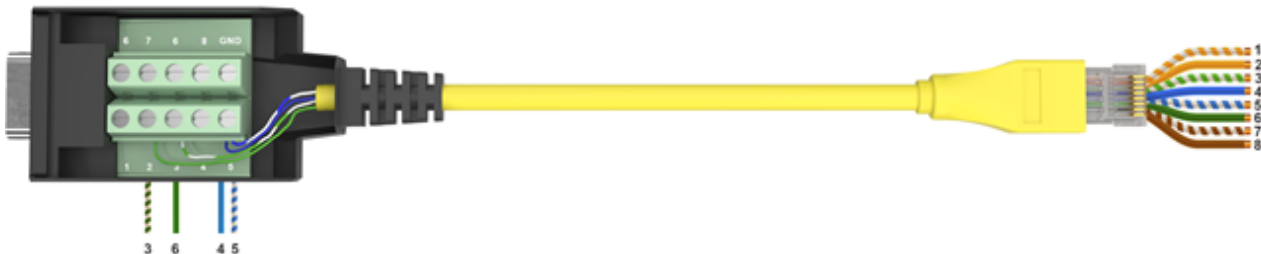
Рисунок 1 – Соединения разъемов консольного кабеля RJ45-DB9
