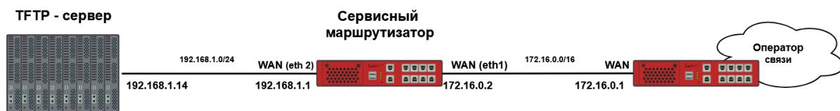
Рисунок 2 – Применение профилей, скачанных через TFTP-сервер
