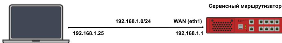
Рисунок 8 – Схема настройки удаленного доступа по протоколу SSH
