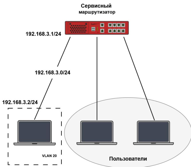
Рисунок 7 – Схема настройки локальной сети
