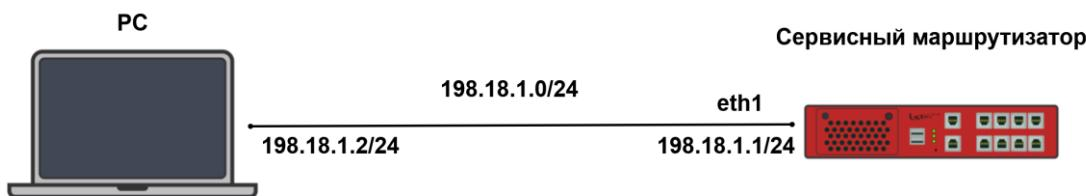
Рисунок 9 – Схема настройки протокола Telnet
