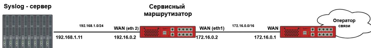
Рисунок 12 – Схема настройки журналирования событий на удаленный Syslog-сервер
