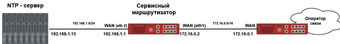
Рисунок 13 – Настройка синхронизации времени с NTP-сервера
