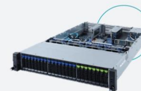
ARBYTE ALKAZAR+ R2G, R4G Установка до 8 GPU в одном сервере
