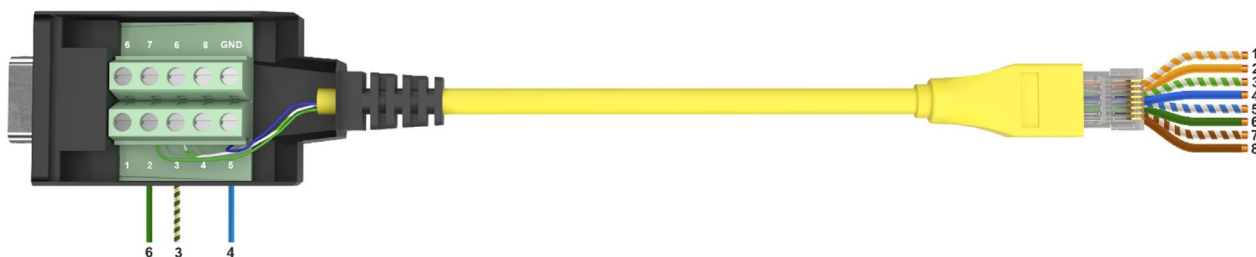
Рисунок 1.2 – Распределение контактов разъемов кабеля для СМ выпуска ранее 05.2024
