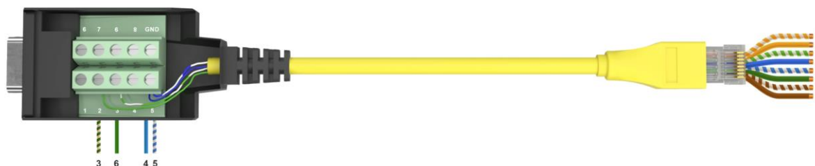
Рисунок 44 – Схема распыки консольного кабеля
