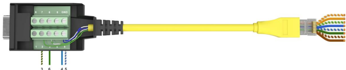
Рисунок 31 – Схема распайки консольного кабеля
