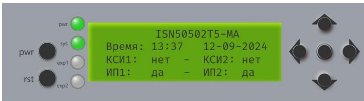
Рисунок 1.4 – Пример состояния дисплея и индикаторов после включения платформы кнопкой PWR
