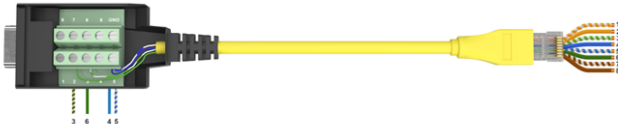
Рисунок 1 – Соединения разъемов консольного кабеля RJ45-DB9
