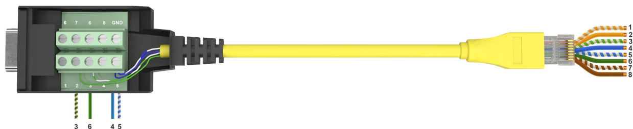
Рисунок 1 – Распределение контактов разъемов кабеля
