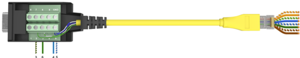
Рисунок 1.1 – Распределение контактов разъемов кабеля консольного RJ45-DB9
