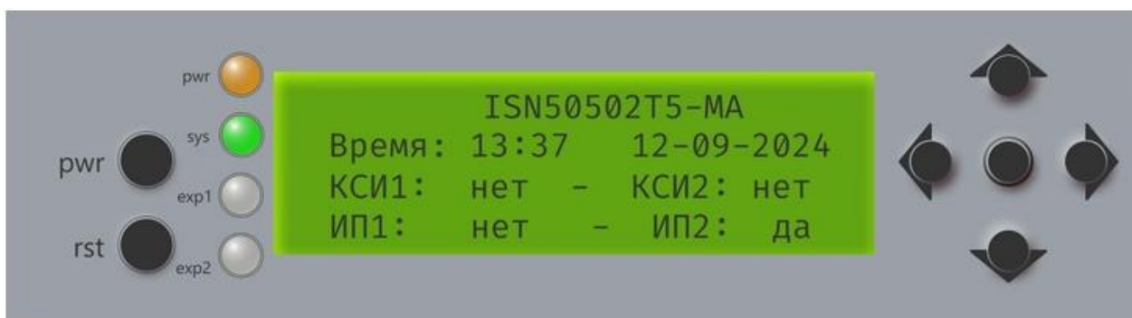
Рисунок 1.22 – Пример стартового экрана при отказе первого блока питания
