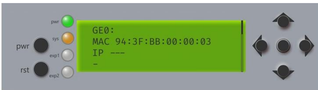
Рисунок 1.16 – Пример идентификации сетевого интерфейса при выключенной аппаратной платформе
