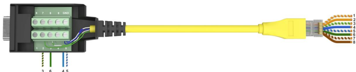
Рисунок 31 – Схема распайки консольного кабеля
