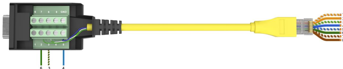
Рисунок 44 – Схема распайки кабеля консольного RJ45-DB9
