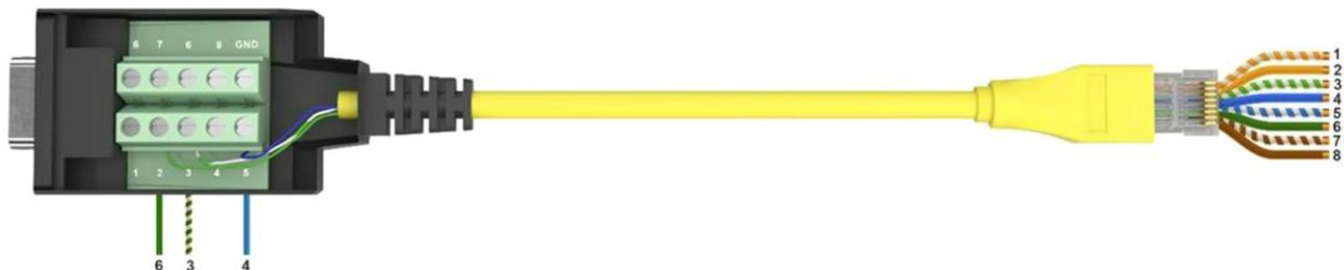
Рисунок 45 – Схема распыки консольного кабеля для СМ выпуска ранее 01.05.2024
