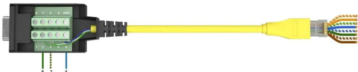
Рисунок 43 – Схема распыки консольного кабеля для СМ выпуска ранее 01.05.2024
