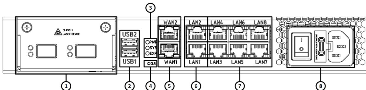
Рисунок 18 – Конфигурация элементов передней панели изделия ISN41508T3-M-AC/ISES1004
