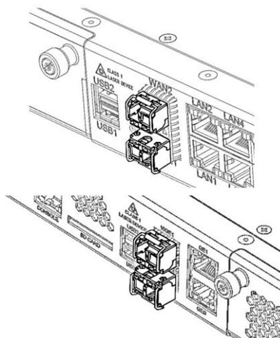
Рисунок 38 – SFP-трансиверы, установленные в слоты изделия
