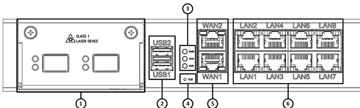
Рисунок 12 – Конфигурация элементов передней панели изделия ISN41508T3-M/ISES1004
