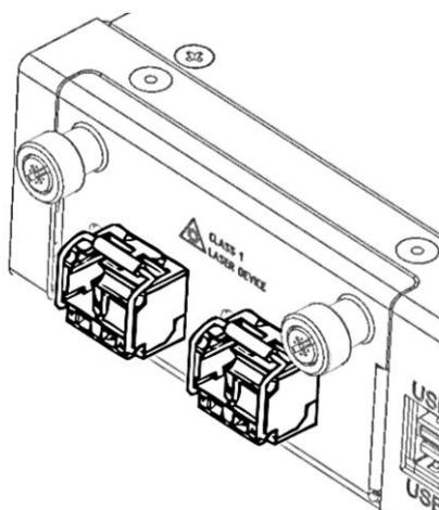
Рисунок 39 – SFP-трансиверы, установленные в слоты модуля расширения
