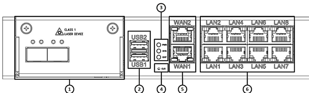
Рисунок 22 – Конфигурация элементов передней панели изделия ISN41508T3-M-AC/ISES0116
