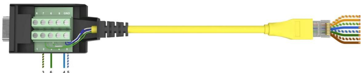
Рисунок 42 – Схема распыки консольного кабеля
