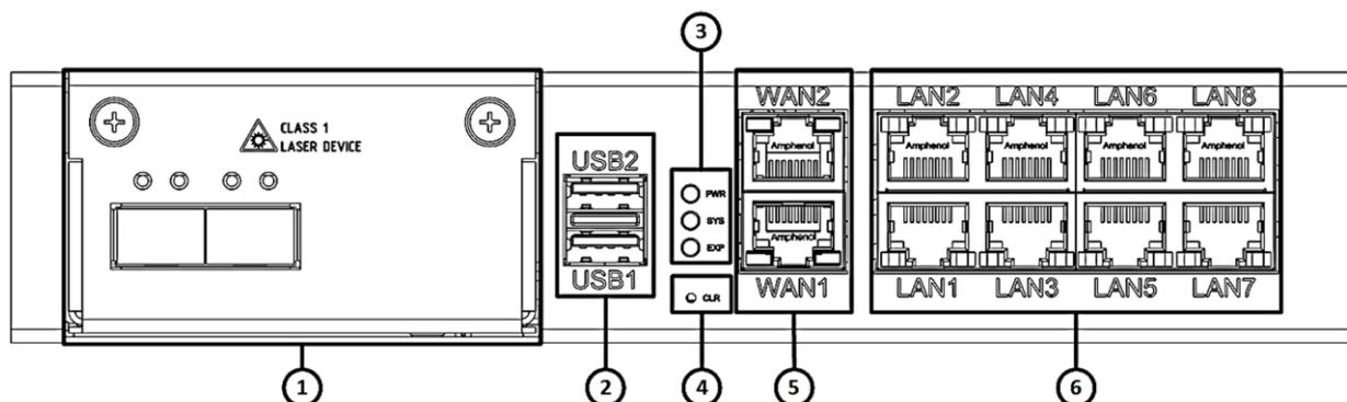
Рисунок 16 – Конфигурация элементов передней панели изделия ISN41508T3-M/ISES0116
