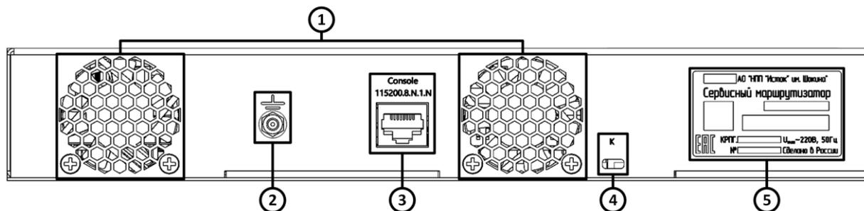
Рисунок 10 – Конфигурация элементов задней панели изделия ISN41508Т3-М-АС
