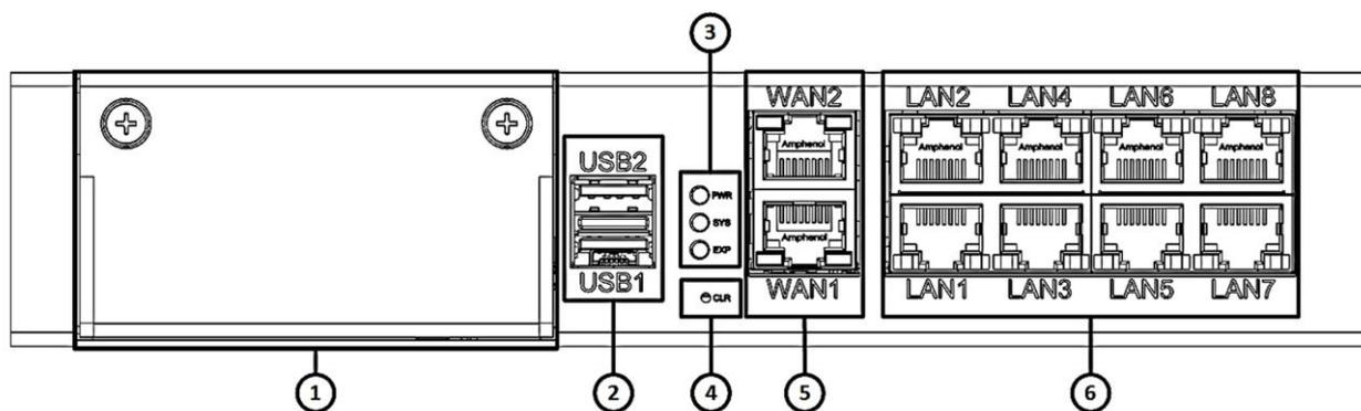
Рисунок 5 – Конфигурация элементов задней панели изделия ISN41508T3-M
