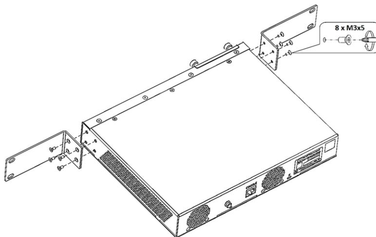
Рисунок 33 – Крепление кронштейнов из комплекта для монтажа в стойку
