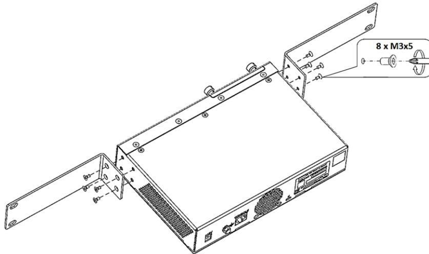
Рисунок 32 – Крепление кронштейнов из комплекта для монтажа в стойку
