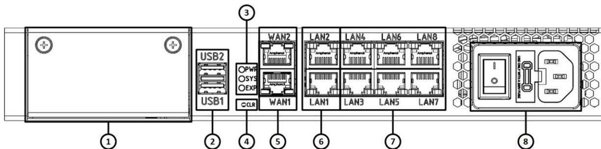
Рисунок 9 – Конфигурация элементов передней панели изделия ISN41508T3-M-AC
