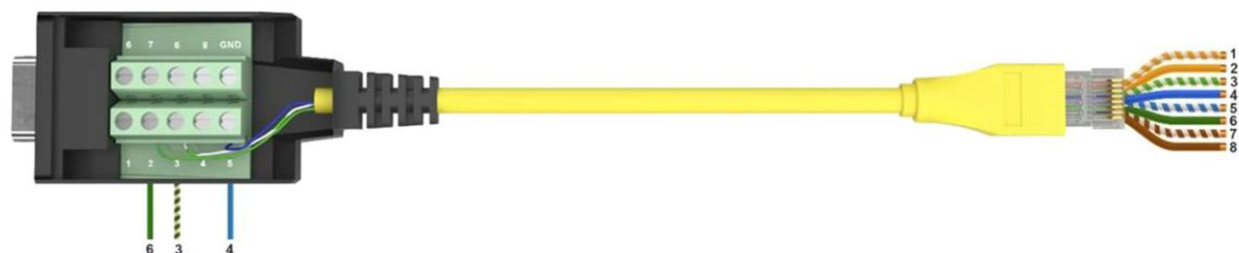
Рисунок 2 – Распределение контактов разъемов кабеля для СМ выпуска ранее 05.2024
