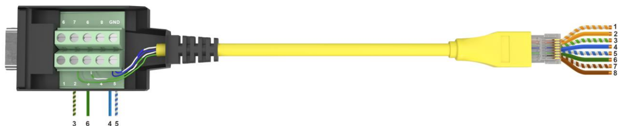
Рисунок 1 – Распределение контактов разъемов кабеля
