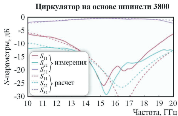
Рис. 8. Экспериментальные результаты в сравнении с расчетными для модифицированной феррошпинели
