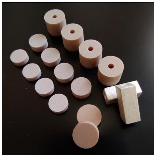
Рис. 1.3. Диэлектрические резонаторы без отверстия и с отверстием.
