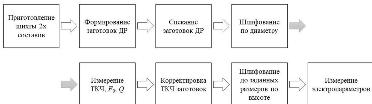
Рис. 4.1. Основные этапы изготовления составных монолитных ДР
