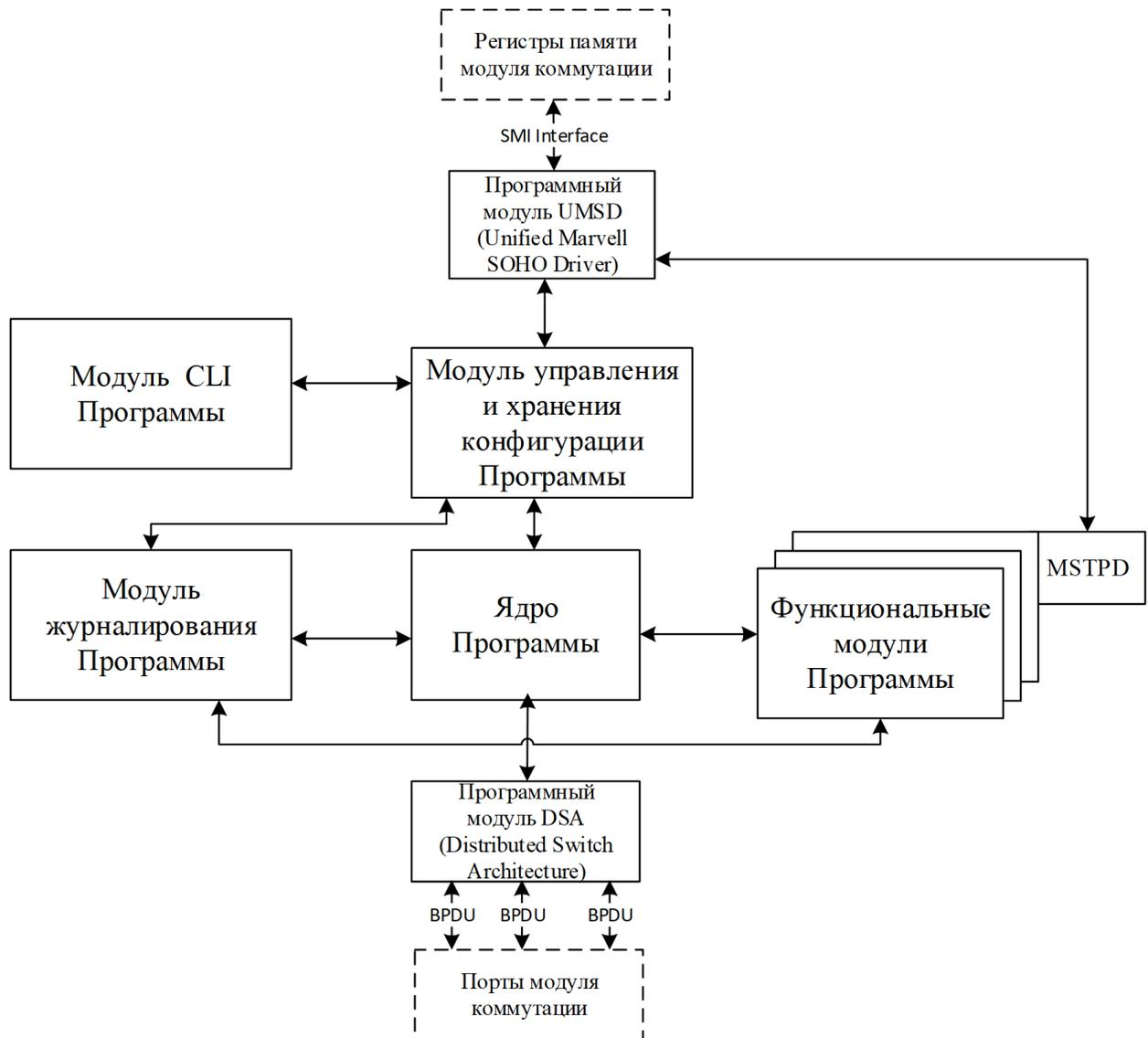
Рисунок 1 – Структурная схема программы
