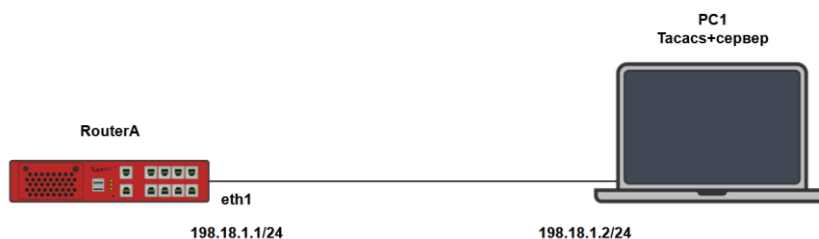
Рисунок 120 – Логическая схема протокола TACACS
