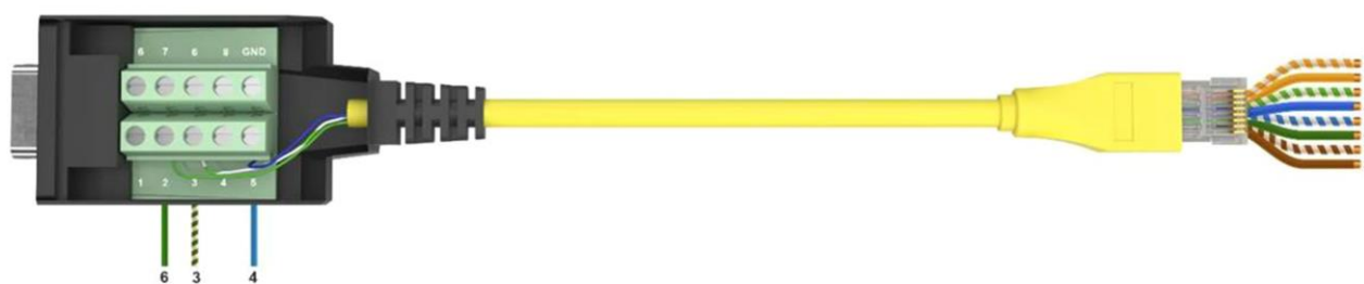
Рисунок 1.1 – Распределение контактов разъемов кабеля консольного RJ45-DB9 КРПГ.465965.002
