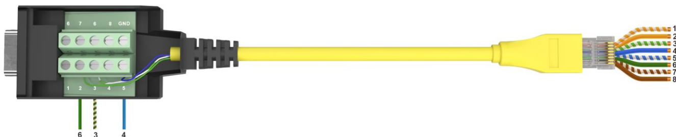
Рисунок 65 – Схема распайки кабеля консольного RJ45-DB9
