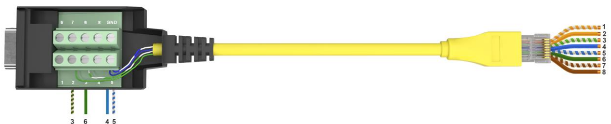
Рисунок 1 – Распределение контактов разъемов кабеля
