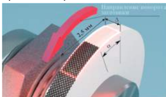
Рис. 4. Обработка цилиндрической поверхности диска из ПНБ методом лазерной абляции
