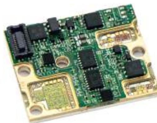
Рис. 6. Приемопередающий канал для ППМ АФАР X-диапазона
