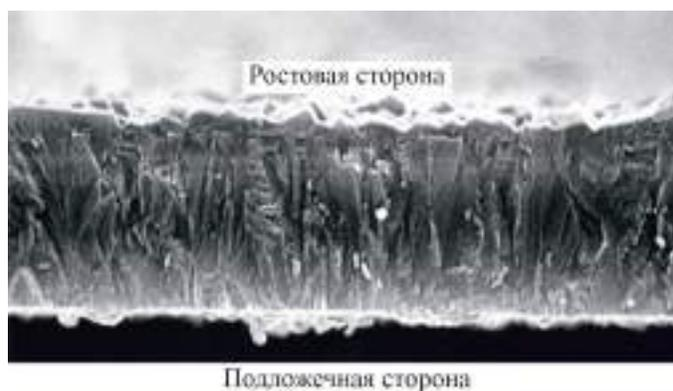
Рис. 1. Торец пластины поликристаллического алмаза после процесса роста
