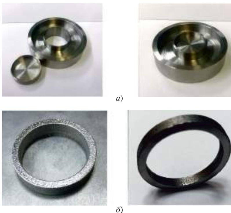
Рис. 10. Аддитивные имитаторы корпуса гироскопа из сплава 80НХС (а) и аддитивные кольцевые магниты из сплава 25Х15К (б)
