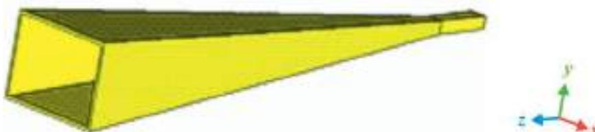
Рис. 1. Согласующий рупор
