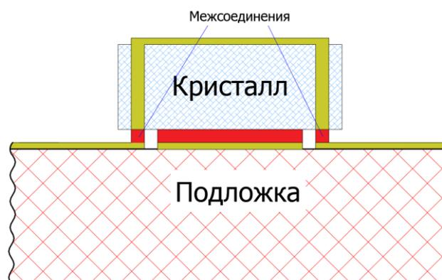
Рис. 16. Концепция интеграции кристалла методом hot-via
