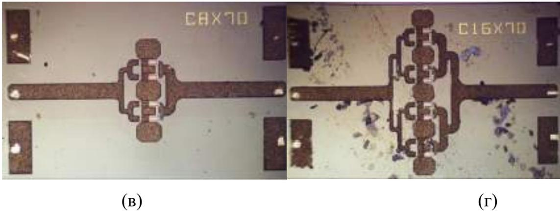
Рис. 3.3 Фотографии транзисторов с шириной единичного пальца затвора 70 мкм: (а) транзистор с 2-мя пальцами затвора, (б) транзистор с 4-мя пальцами затвора, (в) транзистор с 8-ю пальцами затвора, (г) транзистор с 16-ю пальцами затвора (сгорел в ходе измерений, видны разрушения конструкции)
