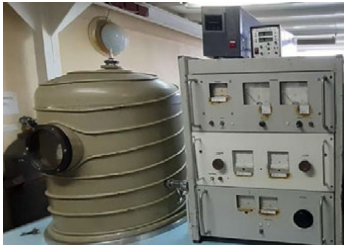
Рисунок 1.8 – Установка ионно-плазменного напыления эмиссионного покрытия МНОК
