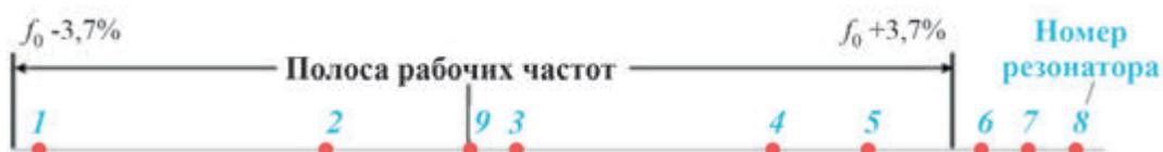
Рис. 6. Настройка частот модернизированной резонаторной системы с выходным двухзворным резонатором и полосой 7,4 %
