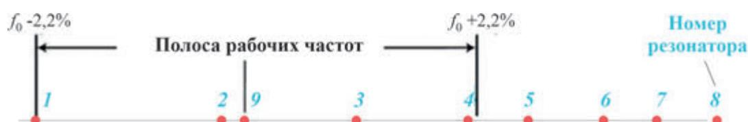
Рис. 3. Расстройка частот резонаторов группирователя клистрона относительно центральной частоты  $f_0$  рабочей полосы частот
