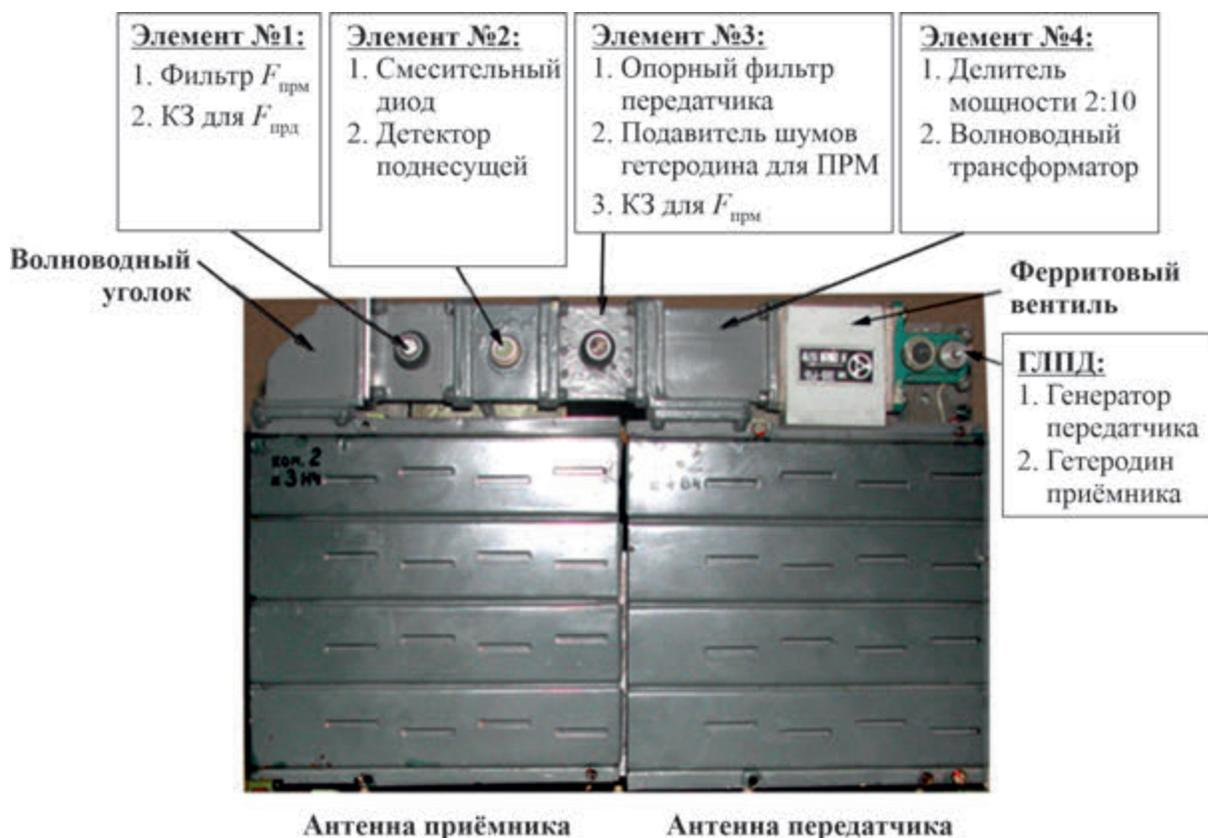
Рис. 3. Волноводная система радиостанции Р-622 и функции ее элементов
