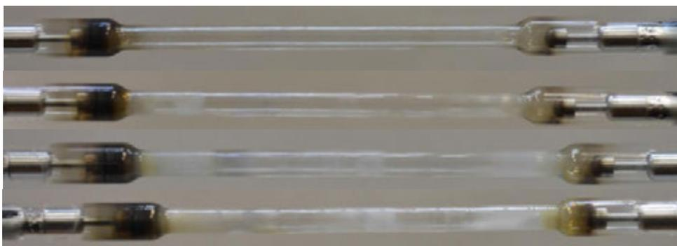
Рисунок 52 – Фотографии импульсной лампы 3x80 при различной наработке в млн. импульсов
