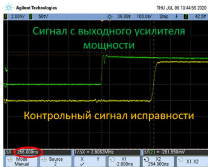
Рис. 49. Задержка реагирования системы контроля мощности
