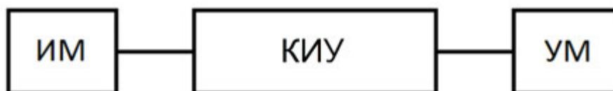
Рис. 39. Структурная схема стенда для измерений СВЧ-потерь СВЧ-соединителя при воздействии высокого уровня мощности
