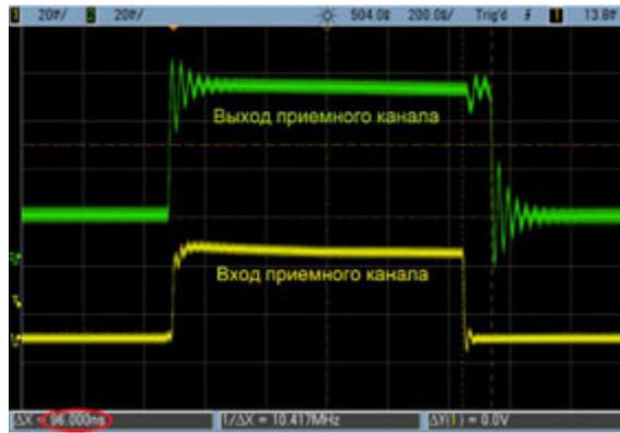
Рис. 86. Полученные экспериментальные результаты измерений времени восстановления коэффициента передачи приемного канала после воздействия на вход импульса мощности 8 Вт
