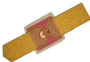
Рис. 8. Бескорпусной GaAs диод ZB-27
