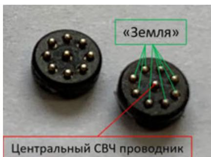
Рис. 25. Межплатный прижимной СВЧ-соединитель
