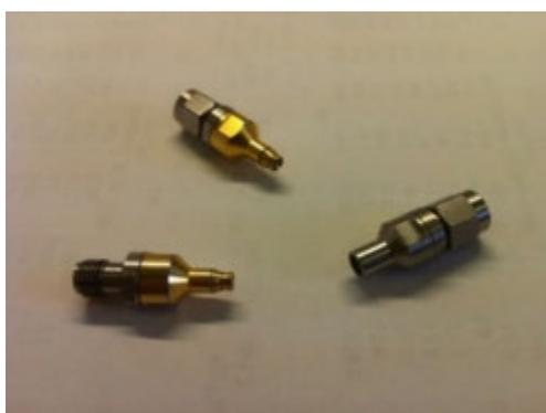
Рис. 34. СВЧ-переходы с SMA на SMP фирмы Rosenberger
