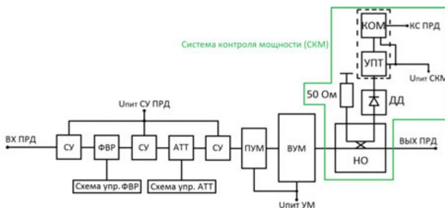
Рис. 14. Схема системы контроля мощности передающего канала ППМ
