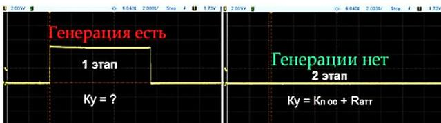
Рисунок 11 – Амплитуда контрольного сигнала СКМ при проверке коэффициента усиления с помощью ПОС
