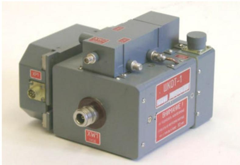
Рис. 5.4. Фото ЦЗКУ диапазона длин волн 10 см. СВЧ вход ЦЗКУ – коаксиальный сечением 7/3,04 мм.
