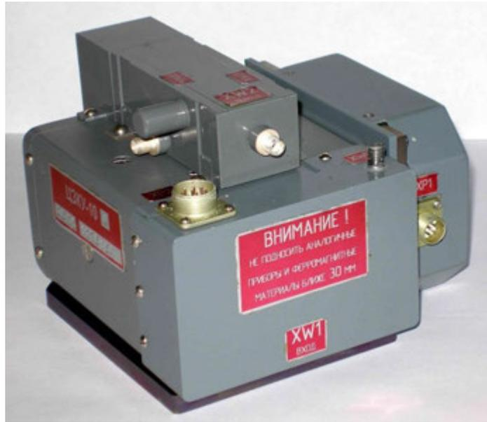
Рис. 5.3. Фото ЦЗКУ диапазона длин волн 3 см. Фланец входного волновода совмещен с крепежным фланцем ЦЗКУ (расположен снизу).
