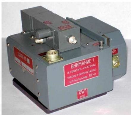
Рис. 19. Фото ЦЗКУ диапазона длин волн 3 см. Фланец входного волновода совмещен с крепежным фланцем ЦЗКУ (расположен снизу).
