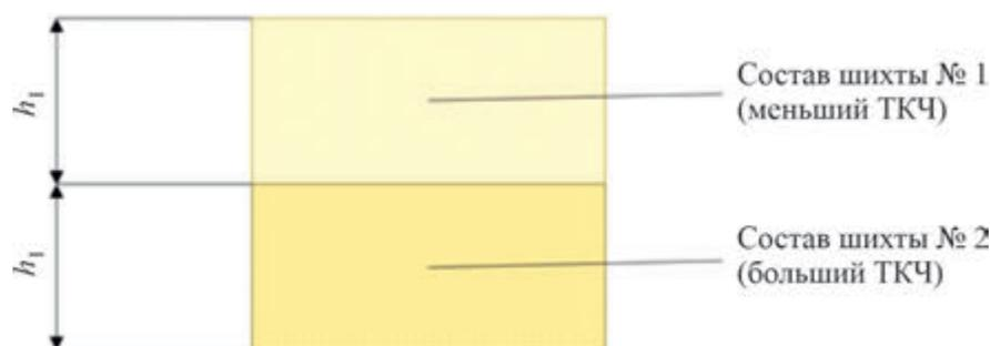
Рис. 3. Эскиз заготовки ДР
