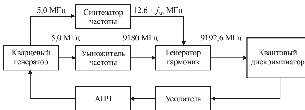
Рис. 1. Структурная схема квантового стандарта частоты на основе АЛТ
