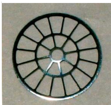
Рис. 3. Сферическая сетка из молибдена толщиной 0,1 мм
