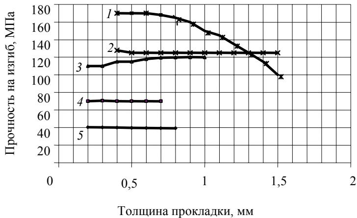
Рис. 1. Зависимости механической прочности спаев керамики КТ-30 с металлами от толщины металлической прокладки:
