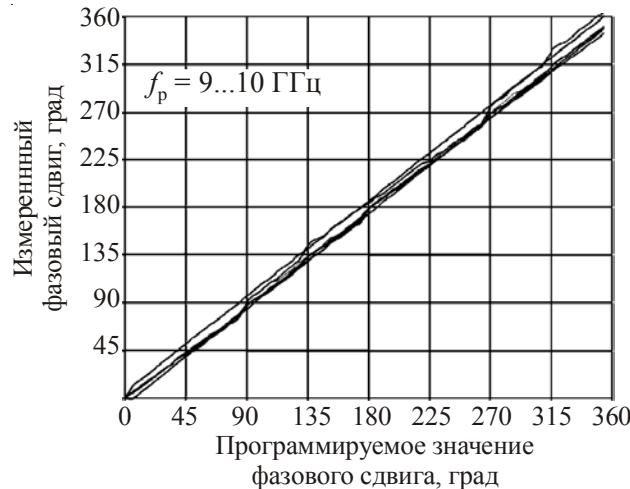
Рис. 9. Типичные параметры по точности установки фазового сдвига 6-битного фазовращателя M44146, измеренные в рабочем диапазоне частот
