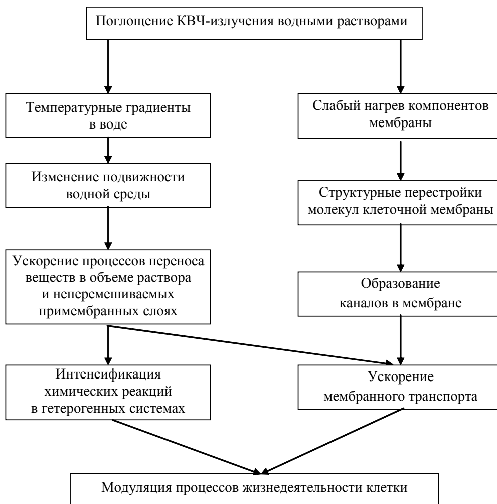
Рис. 6. Механизм действия мм-волн в условиях биологического эксперимента при слабом нагреве опытного образца излучением
