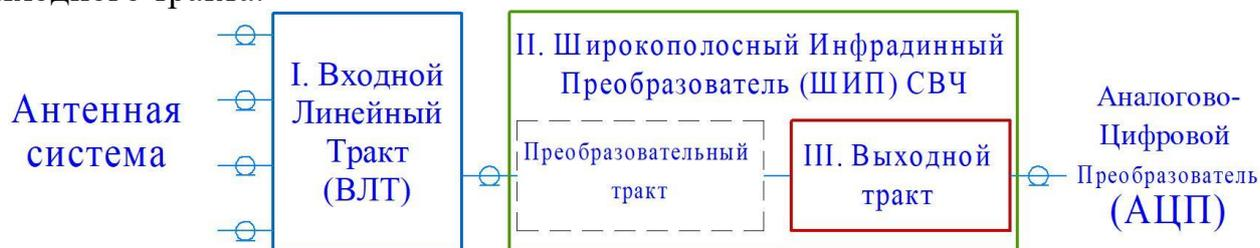
Рис. 1 Упрощенная схема ШПУ СВЧ
