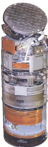
Рис. 5.4 Активная радиолокационная головка самонаведения для ракет класса "воздух-воздух"РВВ-АЕ
