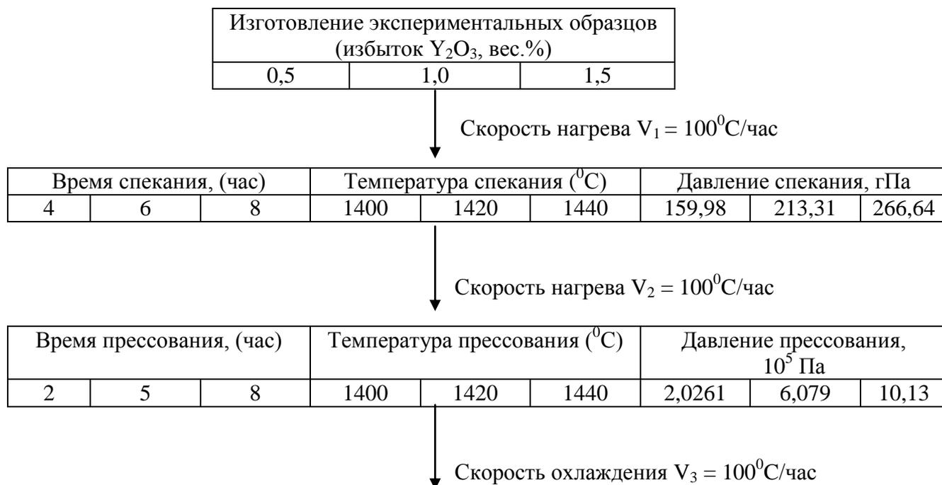
Рис. 3.6 Блок – схема эксперимента по отработке технологического процесса изготовления поликристаллических феррогранатов в регулируемой кислородной атмосфере
