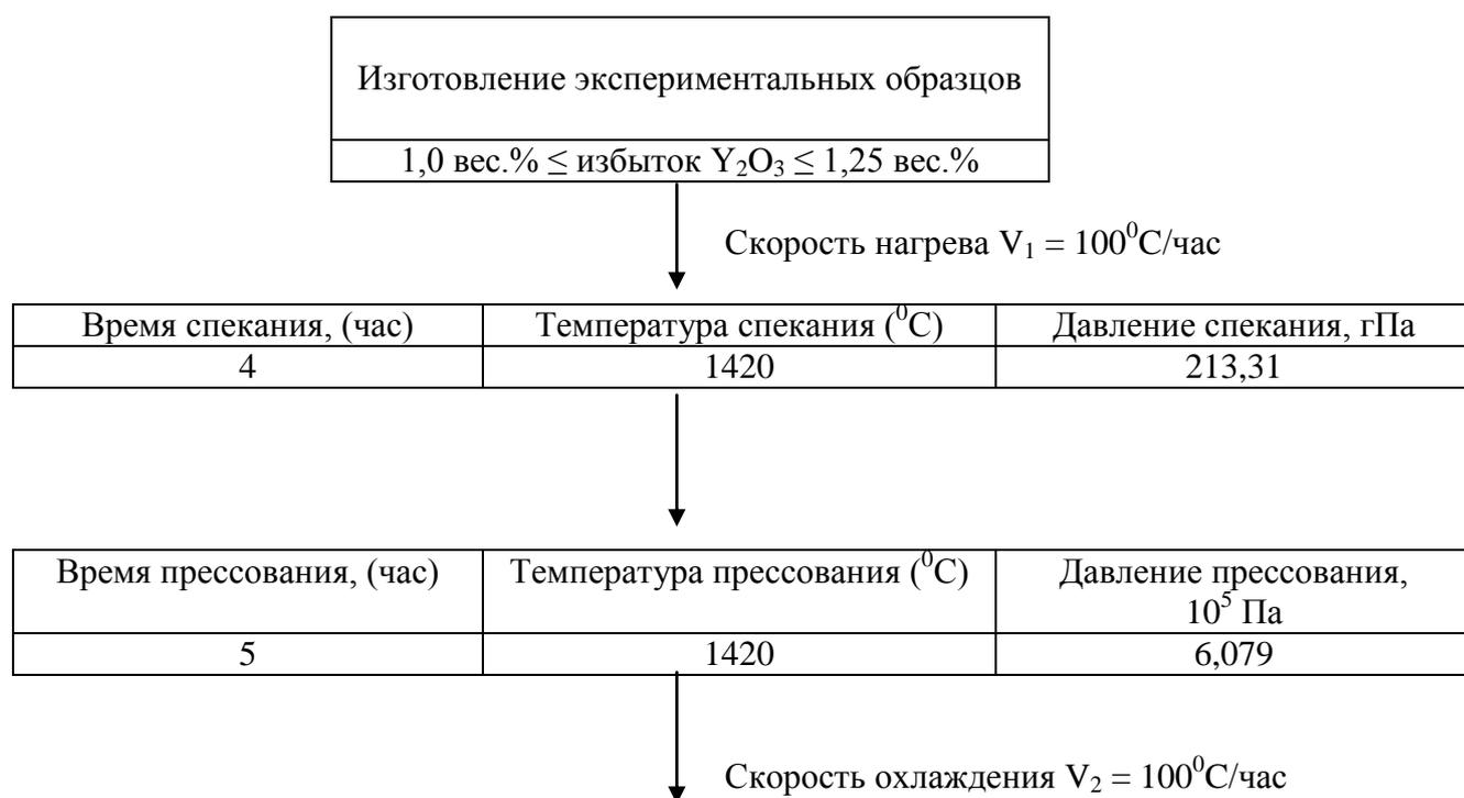
Рис. 3.10 Схема технологического процесса изготовления поликристаллических феррогранатов ФГ-140А, ФГ-96А и ФГ-64А в регулируемой кислородной атмосфере
