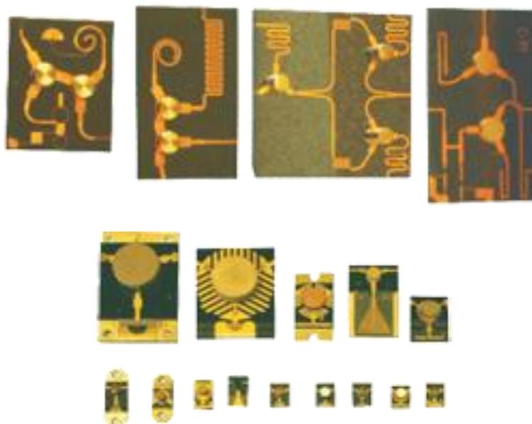
Рис. 5.2 Микрополосковые ферритовые многофункциональные элементы гибридных интегральных схем производства АО «НПП «ИСТОК им. Шокина»
