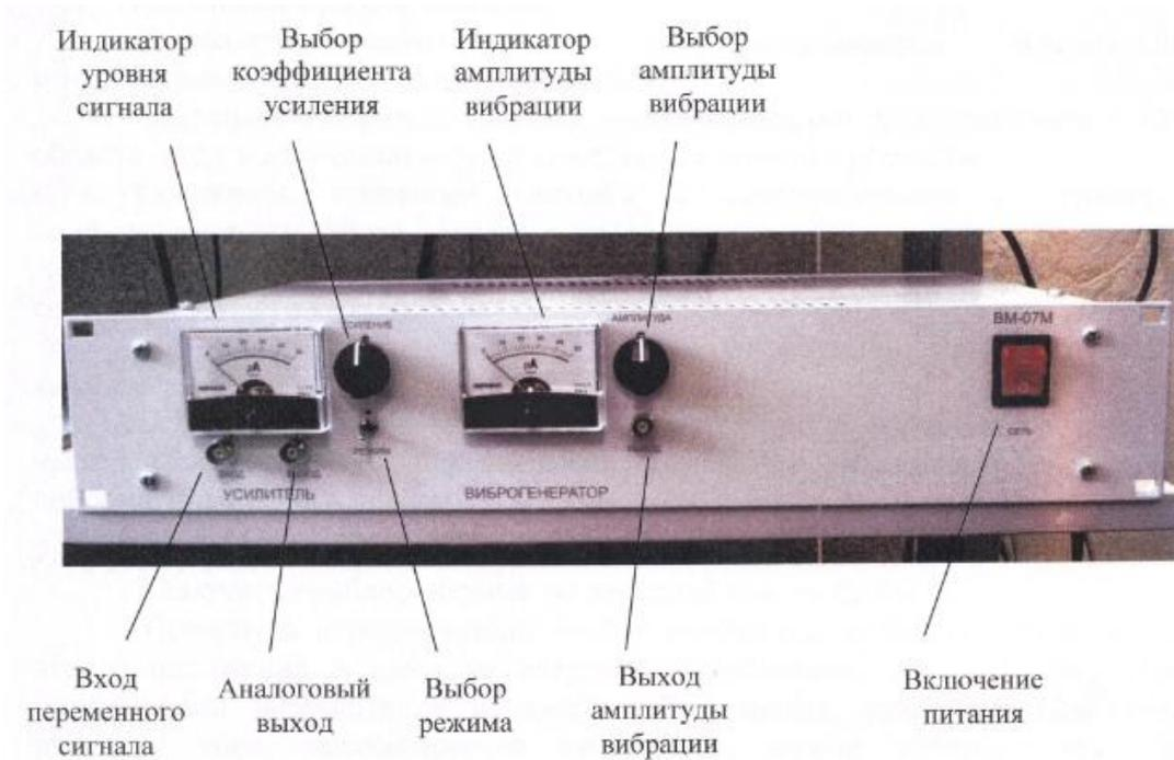
Рисунок 2.10 – Вид передней панели системы регистрации и преобразования сигналов VM-07M
