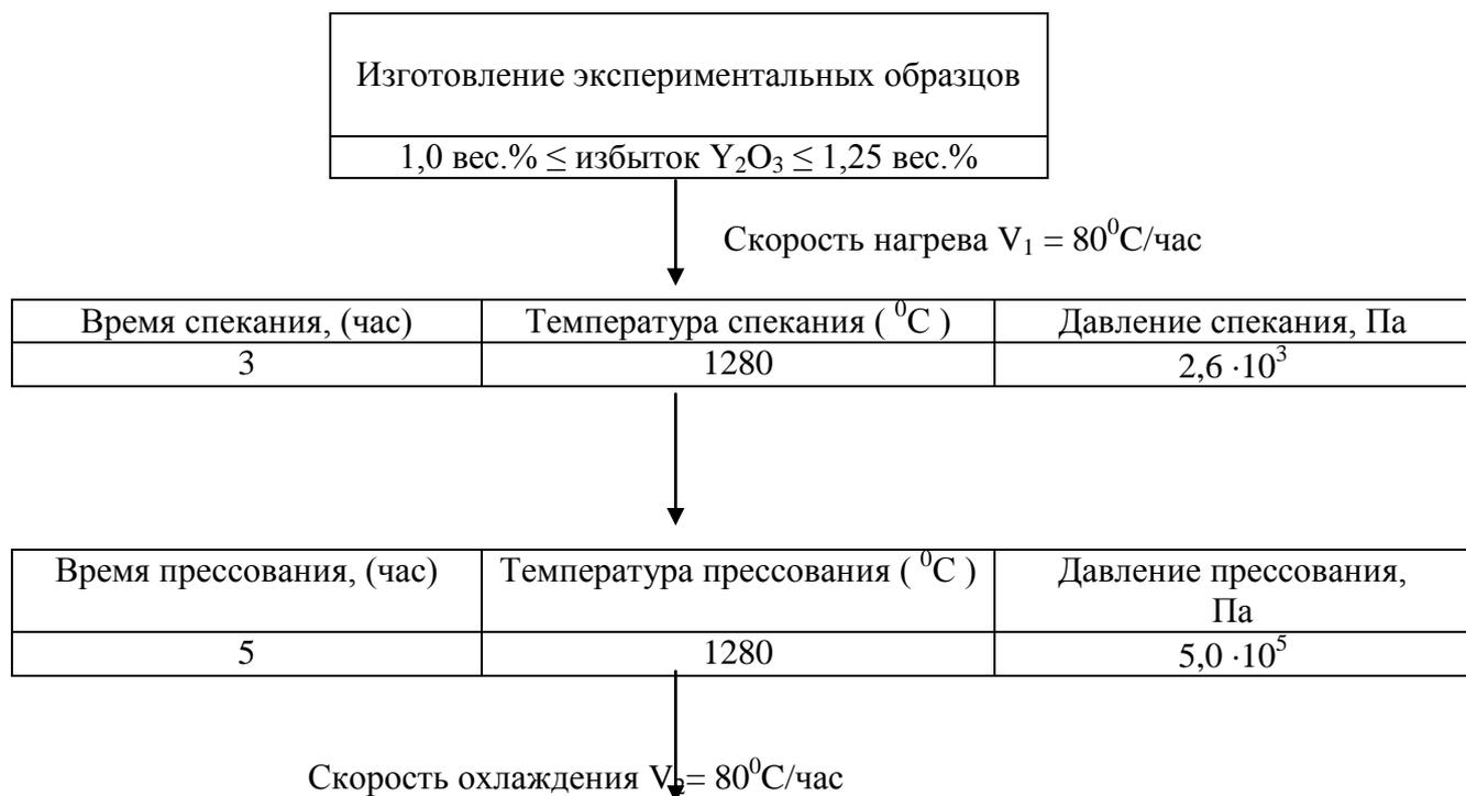
Рис. 4.13 Схема технологического процесса изготовления поликристаллических феррогранатов иттрий-гадолиний-кальций-ванадий-индиевой системы с  $M_S = 32$  кА/м и  $M_S = 48$  кА/м в регулируемой кислородной атмосфере
