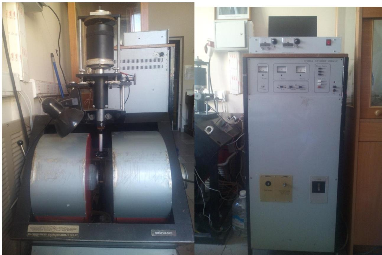
Рисунок 2.7 – Общий вид вибрационного магнетометра ВМ-07М
