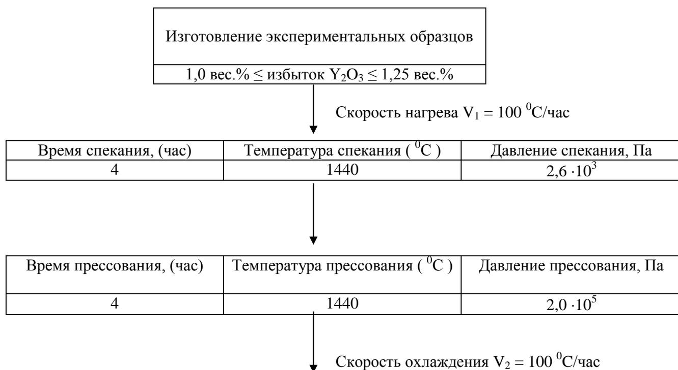
Рис. 4.5 Схема технологического процесса изготовления поликристаллических феррогранатов  $\text{Y}_3\text{Fe}_{4,1}\text{Ga}_{0,9}\text{O}_{12}$  ( $M_S = 32 \text{ кА/м}$ ) и  $\text{Y}_3\text{Fe}_{4,25}\text{Ga}_{0,75}\text{O}_{12}$  ( $M_S = 48 \text{ кА/м}$ ) в регулируемой кислородной атмосфере
