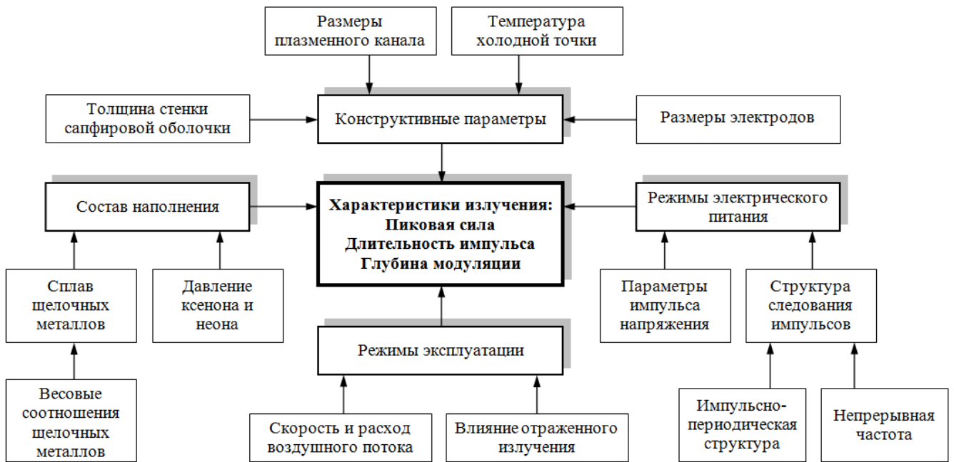
Рисунок 1. Основные факторы, определяющие характеристики излучения газоразрядной лампы с разрядом в парах щелочных металлов.
