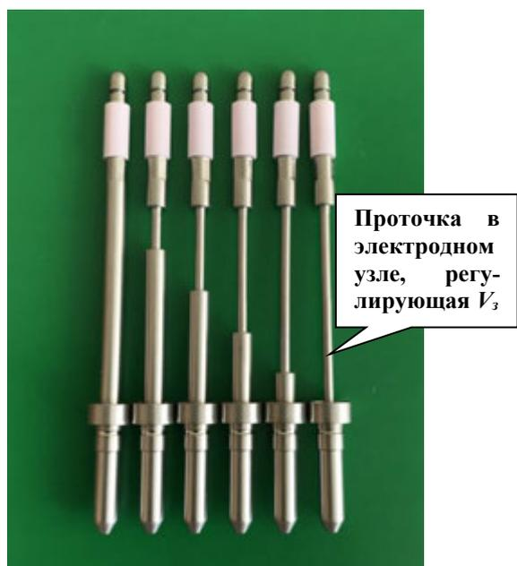
Рисунок 2.9. Фото электродных узлов, демонстрирующее способов регулирования заэлектродного объема  $V_3$ .
