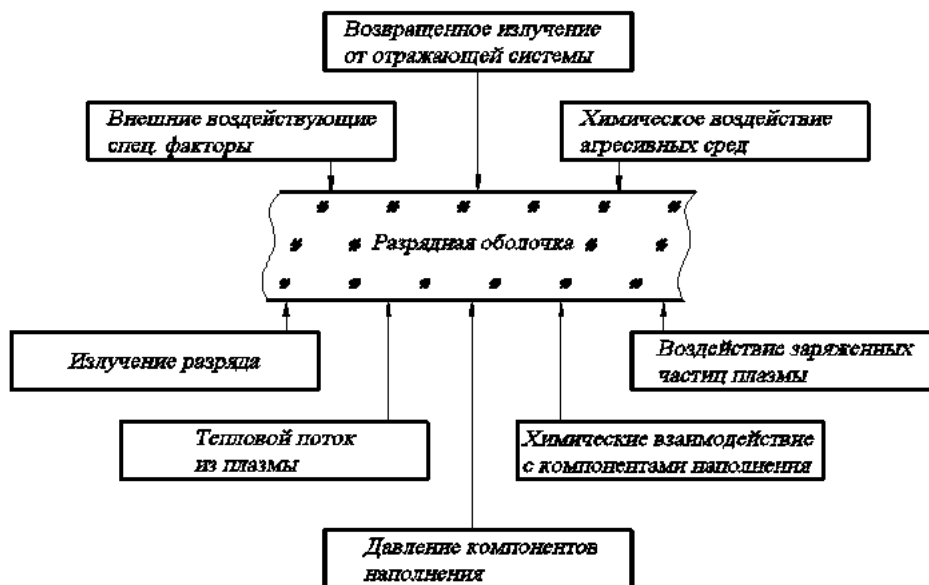
Рисунок 4.2. Схема воздействующих факторов на стенку разрядной трубки
