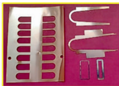
Рис. 4. Оправка для раскроя припоев из олова-золота ПЗЛО80 толщиной 0,025 и 0,03 мм
