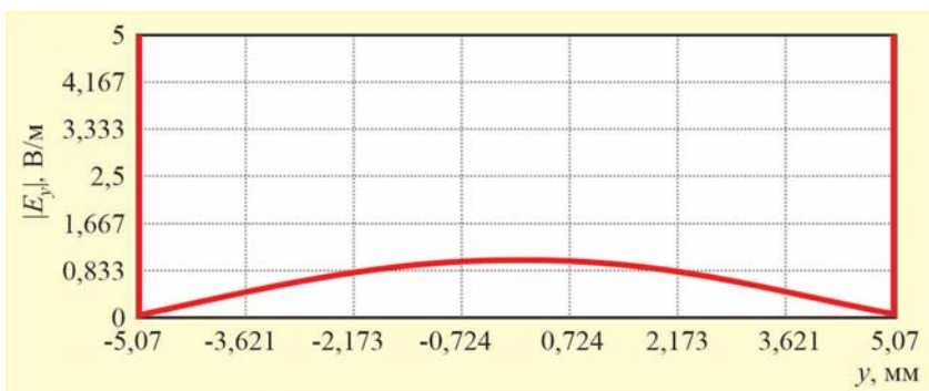
Рис. 6. Эпюра напряженности электрического поля волны LMII
