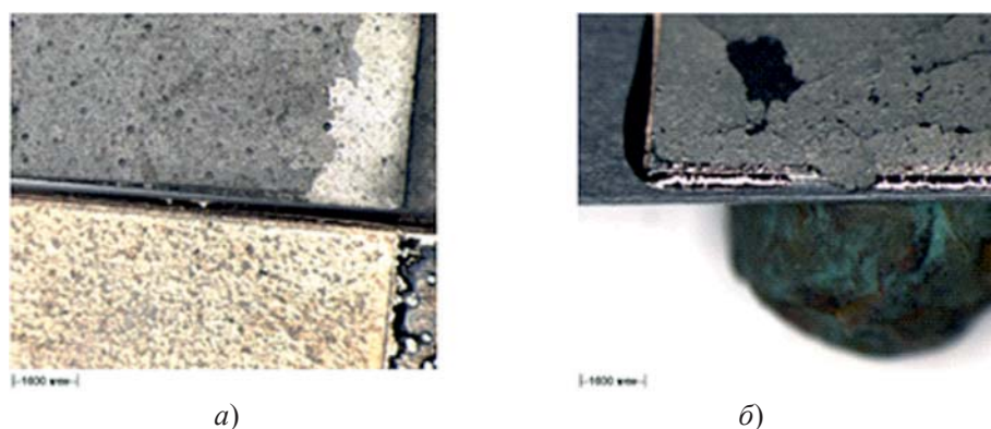
Рис. 4. Спаи по поверхности со стороны базы (а) и со стороны осаждения (б)
